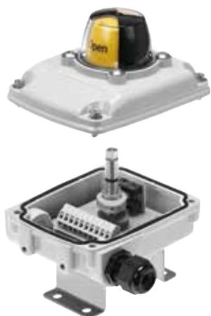
SRBC предельно гибок в применении. Прочная конструкция блока датчиков SRBC идеальна для использования как вне, так и внутри помещений. Корпус из алюминия и монтажный мост из нержавеющей стали, высокий класс защиты IP и NEMA, удобная настройка момента переключения контакта с помощью кулачков и предварительная сборка с монтажным мостом, а также разнообразие типов переключающих контактов, ускоряют и упрощают монтаж и делают работу гибкой и безопасной.
