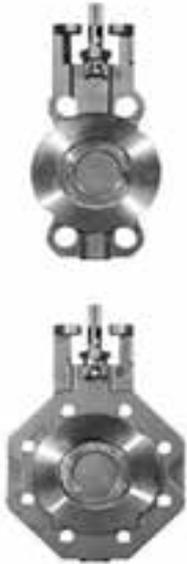
Затворы VZSA-E являются двухэксцентриковыми. Двойной эксцентриситет достигается смещением диска относительно оси вала (z1) и смещением оси диска и оси вала (z2). Пожаробезопасное исполнение: при нормальных условиях работы герметичность обеспечивается PTFE уплотнением, в случае разрушения уплотнения герметичность обеспечивается металлическим уплотнением.
